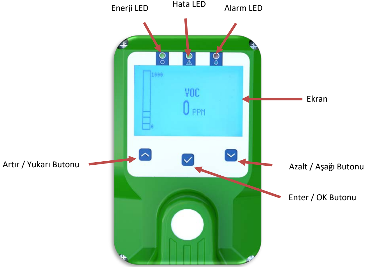
Diagram 8: SAFEVADER Serisi Dedektör Ekran ve LED Göstergeleri
