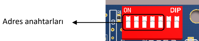
Diagram 9: BTN Serisi dedektör adres anahtarları
